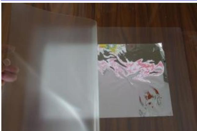
カットしたフィルターをラミネートフィルムにはさみます。30×33cm の分は上図のようにA3のラミネートフィルムの横幅ギリギリになりますが、少しでもフィルムの内側に入っていれば大丈夫です。（上図の角が欠けているのは失敗した部分です）
