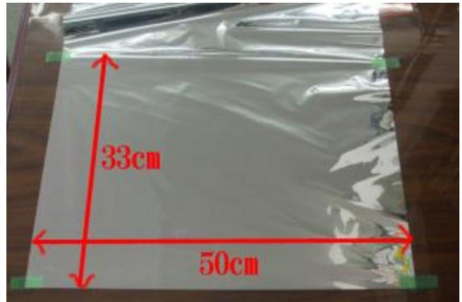
今回はアストロソーラーフィルター (大) サイズを使用した場合をご説明します。大サイズは100×50cmと横長のフィルターですのでA3のラミネートに収まるようカットする必要があります。フィルターを切る時は、切りやすいように四隅をはがしやすいテープで止めると良いです。写真のように全体の1/3にします (33×50cm)
