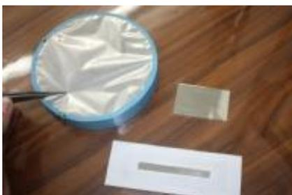
さらにラミネートしたことにより、本来は破れやすく取り扱いには慎重にならないといけないものですが、表面保護の役割となり、十分な耐久性を持たせることができました。標準の使用方法では、ラミネートなど使用せずに左側(円形)のように台紙でフィルターをそのまま望遠鏡の大きさに形を作ります。
