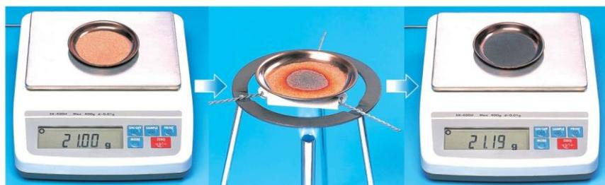
銅の粉末とステンレス皿全体の質量      銅を皿ごと加熱      酸化銅と皿全体の質量
